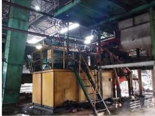
Gambar 4.0 Bentuk Bak Raw Oil (RO)
