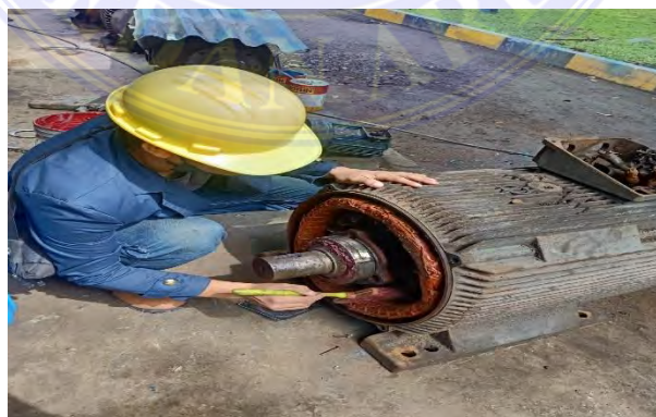
Penggantian Bearing Motor Listrik sekaligus perawatan preventif
