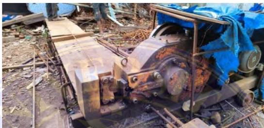
Gambar 4.12 Pemotong Tulangan (*Bar Cutter*)
