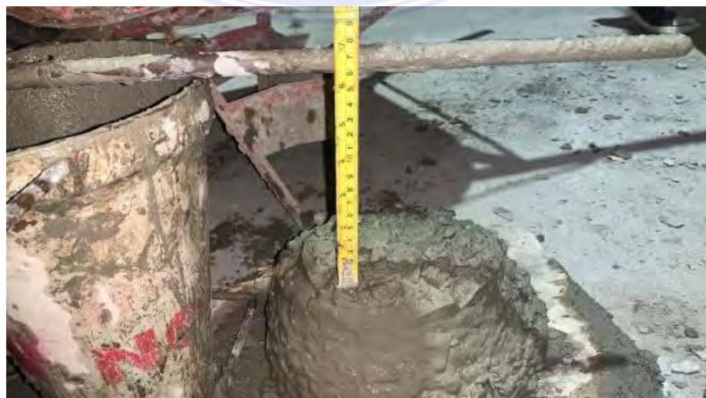
Gambar 3.24 Uji Slump
