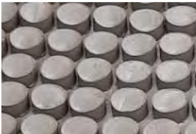
Gambar 4.43 Tahu Beton (*Decking*)
