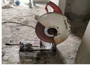
Gambar 4.10 Pemotong Tulangan (*Cutting Wheel*)
