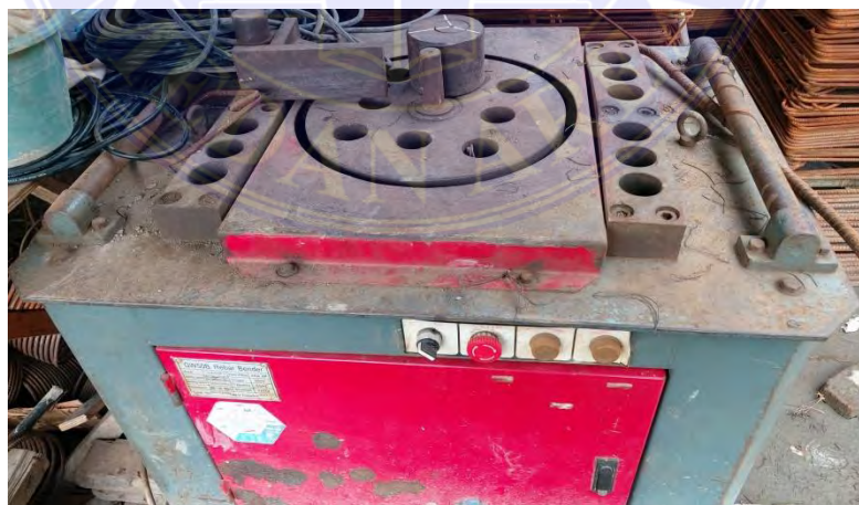
Gambar 3. 6 Bar Bender Sumber : Dokumentasi Lapangan
