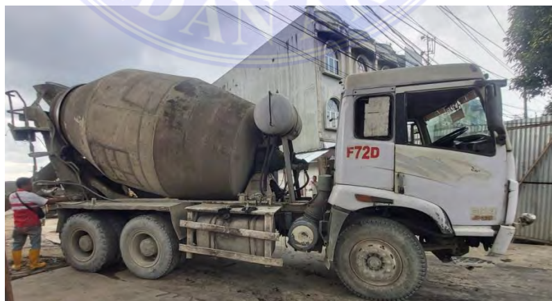
Gambar 3. 1 Truck Mixer Concrete Sumber : Dokumentasi Lapangan
