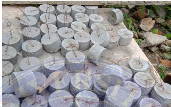
Gambar 2.12 Beton Decking Sumber : Dokumentasi Lapangan
