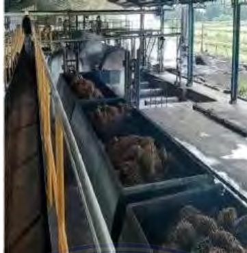
Gambar 3. 10 TBS yang sudah melalui perebusan
