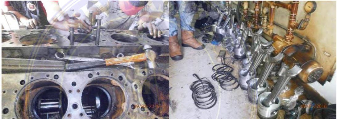
Gambar 4. 5 Proses pengeluaran dan pengecekan piston
