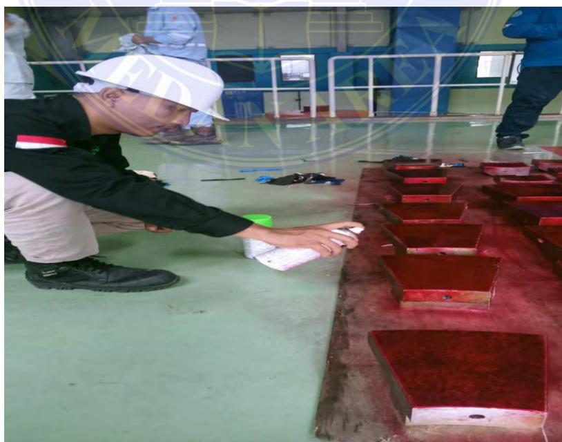
**Dokumentasi 2:** *Inspection* pada turbin bearing dengan metode NDT (*Non Destructif Test*)
