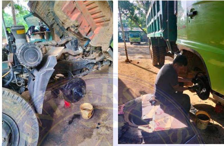
Gambar 1. Perbaikan Rem Bocor Dump Truck Hino 500
