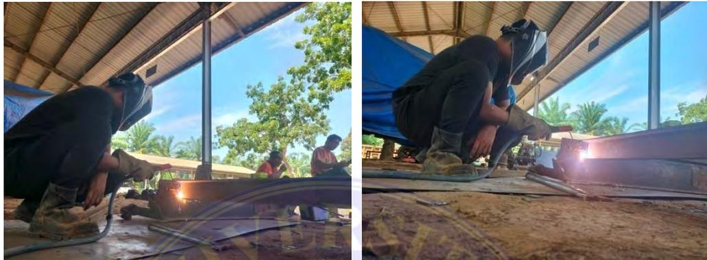
Gambar 3. Proses Pengelasan Bak Trailer
