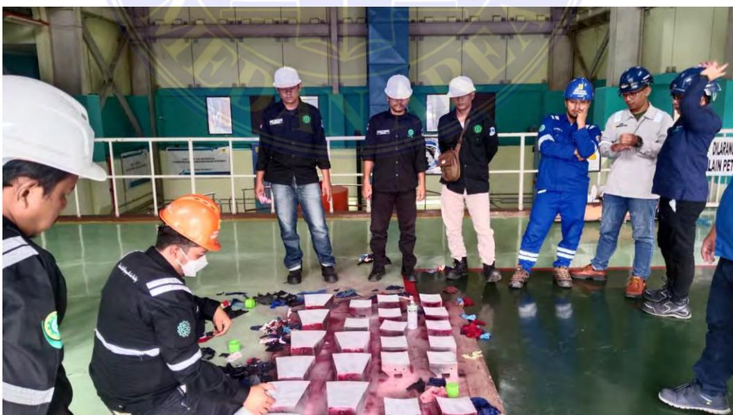
**Dokumentasi 2:** *Inspection* pada turbin bearing dengan metode NDT (*Non Destructif Test*)
