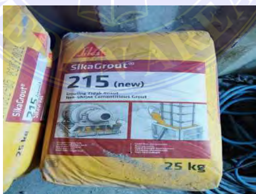
Gambar 3.36 Semen Grouting Sumber : Data Lapangan
