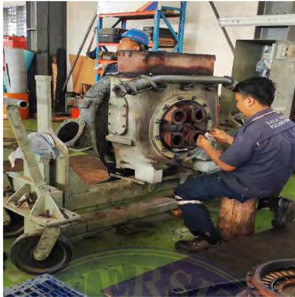
Gambar 3.14. Perawatan P72 Pada *Turbochargers*
