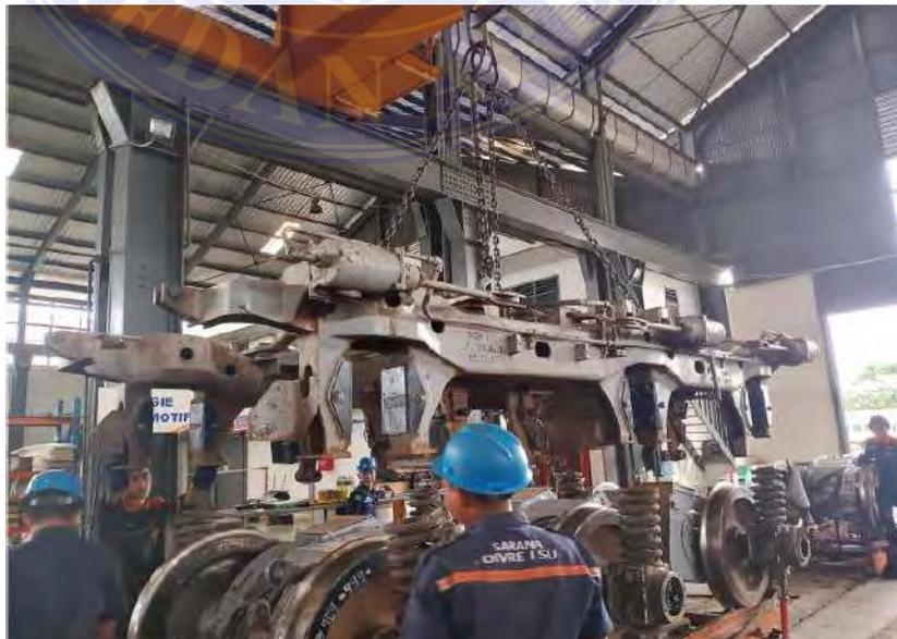
Gambar 3.5. Pengangkatan Rangka bawah
