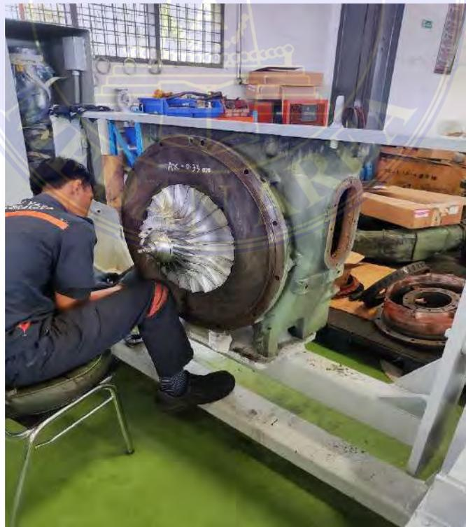
Gambar 3.13. Perawatan *Turbochargers*
