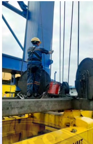
Gambar 3.18. proses Meminyaki ( Lubrication ) tali Kawat Baja ( Wirerope ).
