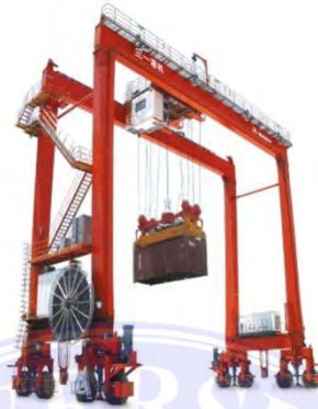
Gambar 3.7. Support Leg pada Rubber Tyred Gantry Craner (Sumber: www.powertec.co.id )
