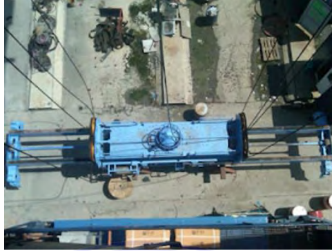
Gambar 3.3. Spreader pada Gantry Crane
