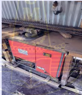
Gambar 3.15 Bar Bender Sumber : Dokumentasi Proyek, 2024
