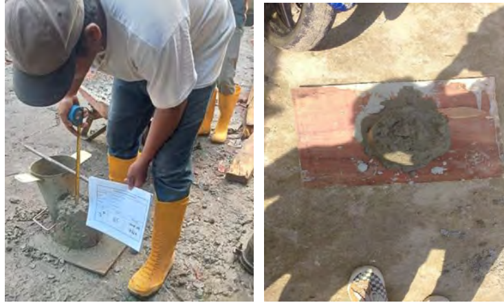
Gambar 4.8 Uji Tes Slump Sumber : Dokumentasi Proyek, 2024
