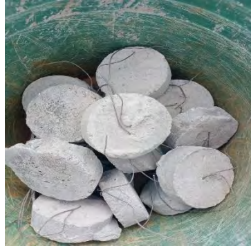
Gambar 3.40 Beton Decking Sumber : Dokumentasi Proyek, 2024
