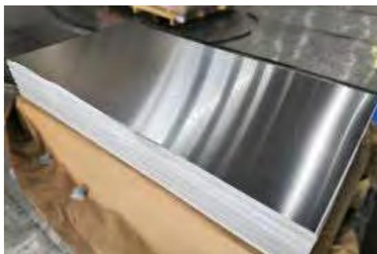
Gambar 3.7. Plat Aluminium Lapisan
