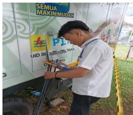
Gambar 4.10 : Pengukuran Arus Pada UPS
