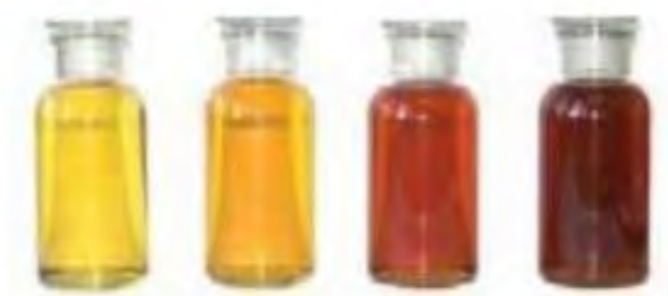
Gambar 4.3 Warna minyak pada trafo
