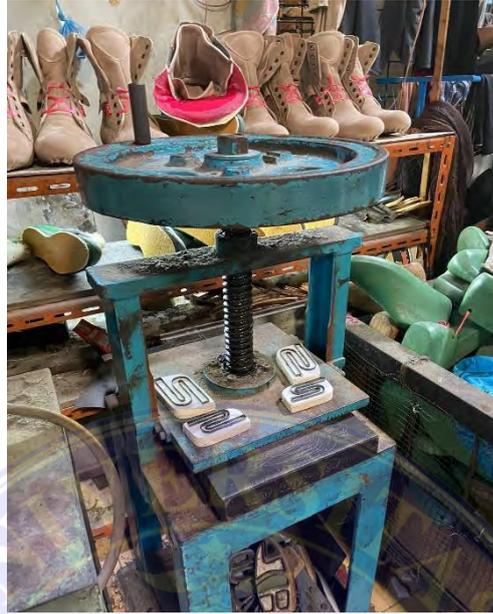
**Gambar 3. 16. Mesin Pengepresan Dengan Plat Bertekanan**
