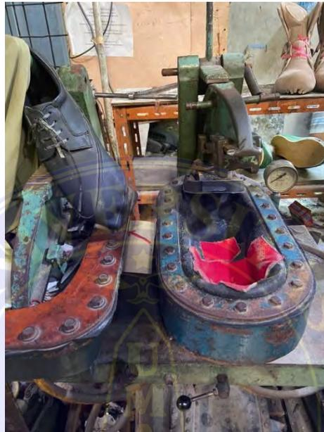
**Gambar 3. 15. Mesin Pelobangan Sepatu**
