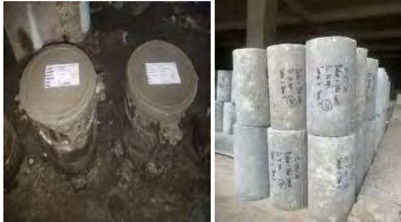
Gambar 4.9 *Sample* Silinder untuk uji kuat tekan beton
