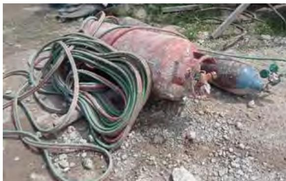
Gambar 3.12 Las Gas atau Las Karbit
