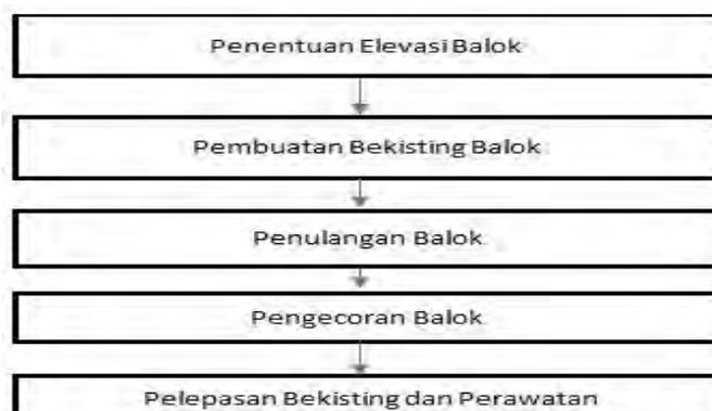
Gambar 4.5 Diagram Alir Pekerjaan Balok
