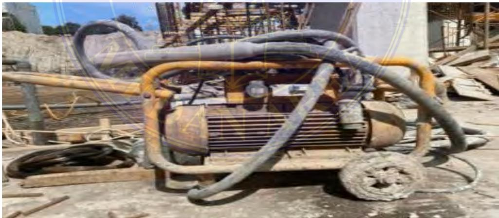
Gambar 8. Mesin *Vibrator*
