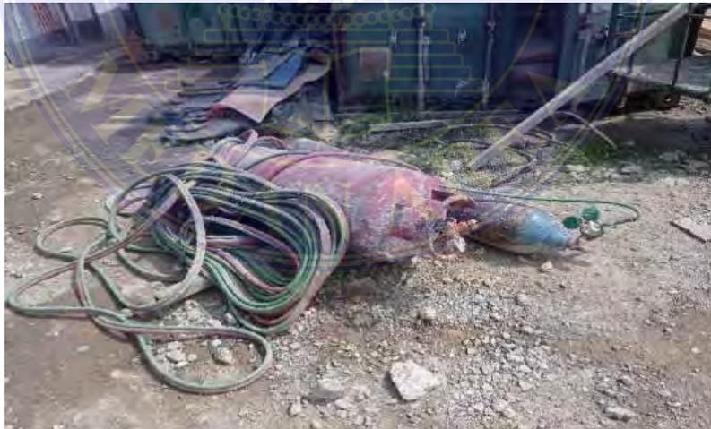
Gambar 3.1.15 *Las Gas* atau *Las Karbit*
