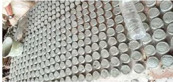
Gambar 4.5 Pembuatan Beton Decking
