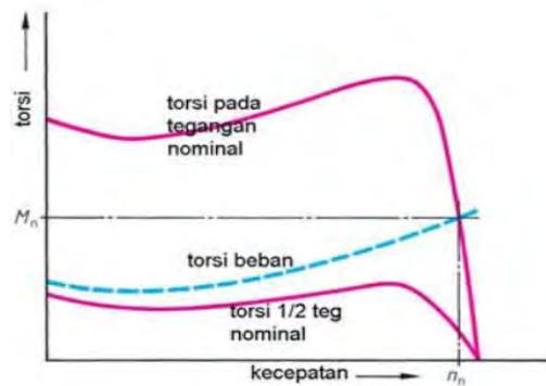
Gambar 16 Karakteristik Torsi *Starting* Dengan Penambahan Tahanan *Stator*
