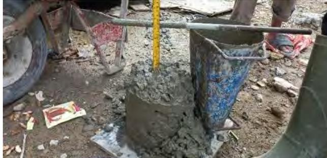
Gambar 4.4.7 Uji Test Slump
