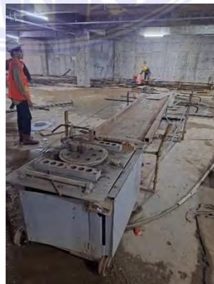
Gambar 4.4.2 Mesin pembengkokan besi tulangan
