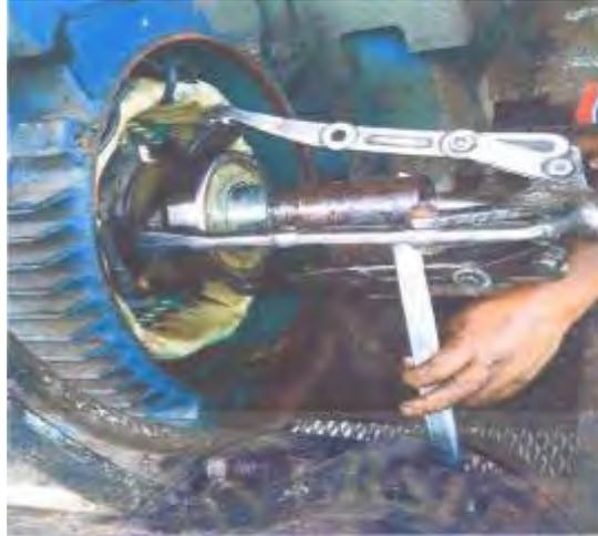
Gambar 4.5: Pengantian bearing dengan menggunakan Treacker
