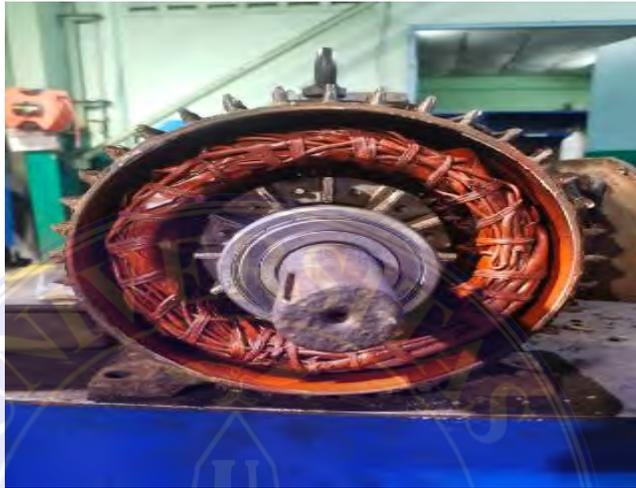
Gambar 2.6: Konstruksi Stator
