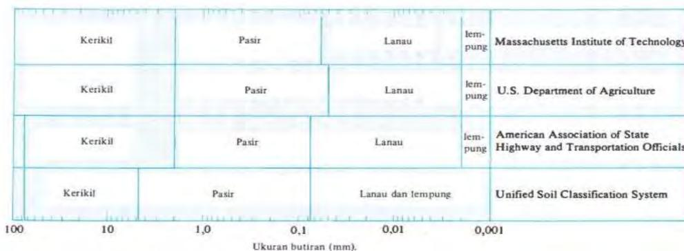
Gambar 1. Batasan –batasan ukuran jenis golongan tanah (Das, 2021)
