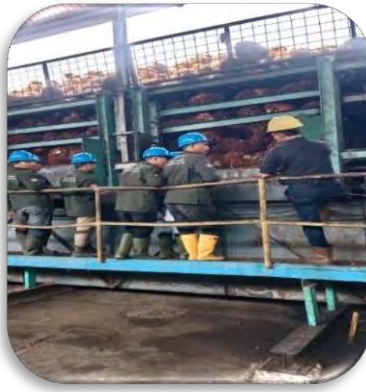
Gambar 9. Loading Ramp (Sumber : Dok. Kelompok, 2024)
