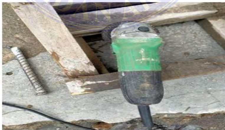
Gambar 7. Gerinda tangan (Sumber : Dokumentasi pribadi, 2023)
