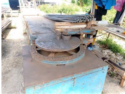
Gambar 3. 27 Bar Bender Sumber : Dokumen Lapangan
