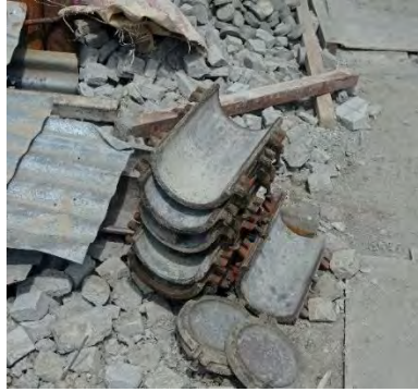
Gambar 3. 25 Bekisting Slinder Sample Sumber : Dokumen Lapangan
