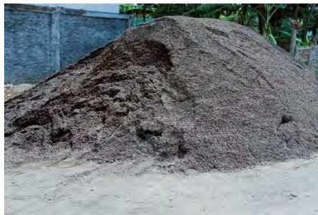
Gambar 2.21 Pasir Beton Sumber: Data Lapangan 2023
