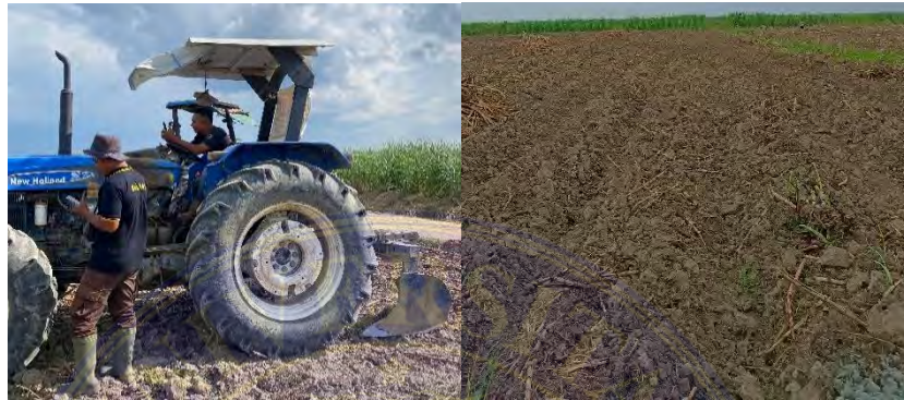
Gambar 4. New Holland 90 HP dengan alat Furrow dan hasilnya.
