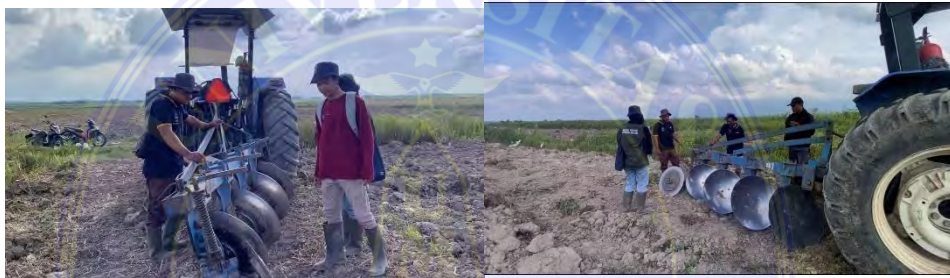
Gambar 2. New Holland 105 HP dengan alat Discplough.
