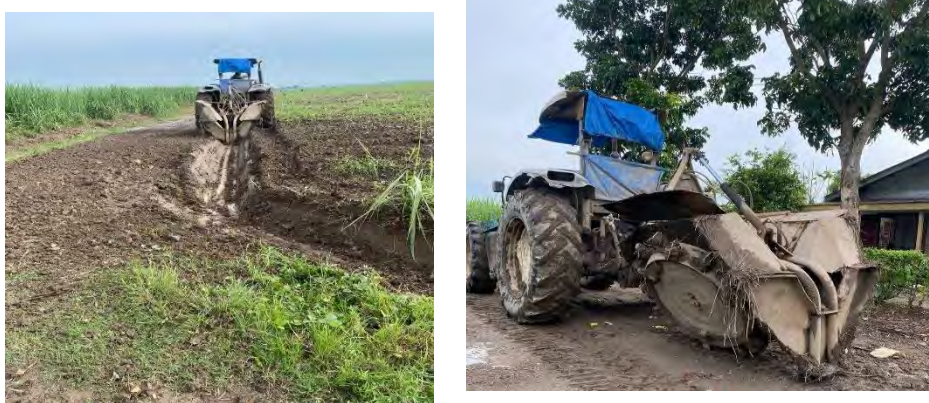
Gambar 5. New Holland 110 HP dengan alat Rotary Ditcher
