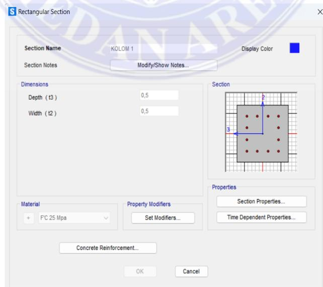
Gambar 9. Pembuatan *Section Properties* ( SAP2000 )
