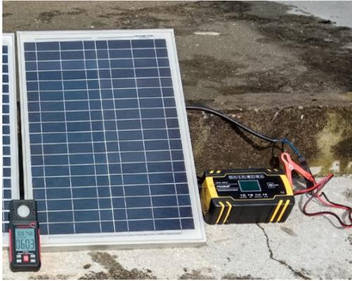
Gambar 4: Instalasi Pengukuran Panel Surya Monocrystalline
