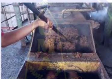
**Gambar 3.94 Pengambilan Sampel di *Screw Press***
