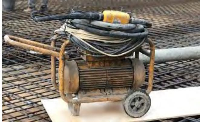
Gambar 3.7 *Vibrator Beton* (Dokumentasi Proyek, 2025)
