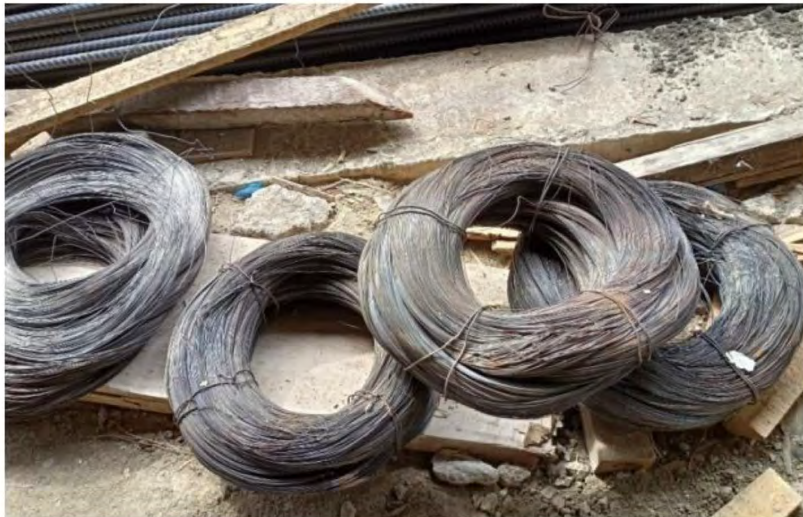
Gambar 3. 34 Bendrat Sumber : Data Lapangan
