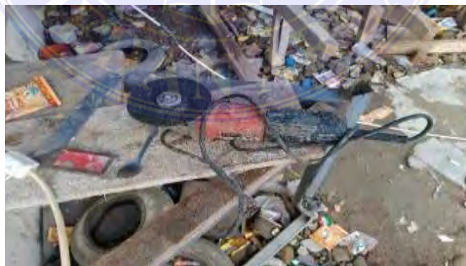
Gambar 3. 20 Gerinda Tangan (Dokumentasi Proyek, 2025)
