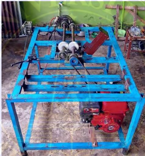
**Gambar.3. 3. Alat Uji Keausan**
