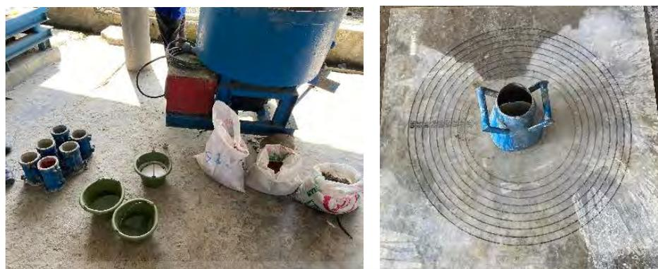
Gambar 6. benda uji: (a) Material Penyusun, Alat pengaduk dan silinder 10 x 20 cm; (b) Alat Slump Cone Test
