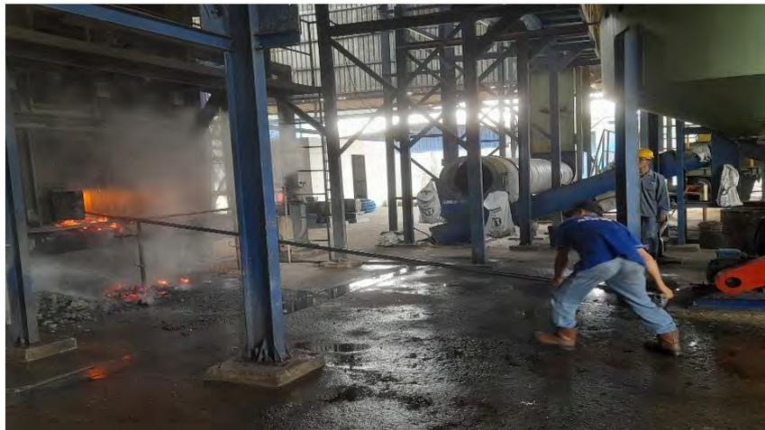
**Gambar 4.1 Pengorekan abu boiler**
