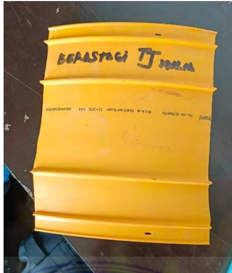
Gambar 3.22. Waterstop (Dokumentasi Lapangan, 2025)
