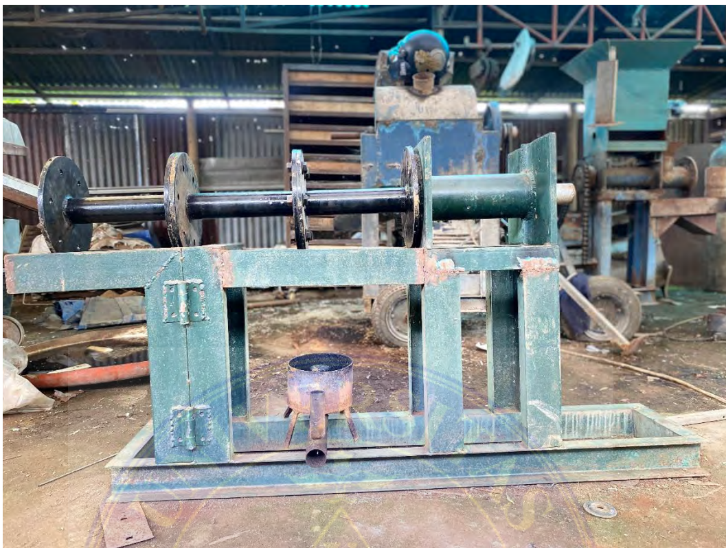
Lampiran 7 Perakitan Flange dan Screw ke rangka
