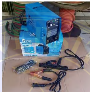
Gambar 3. 11 Trafo Las 450 Watt
