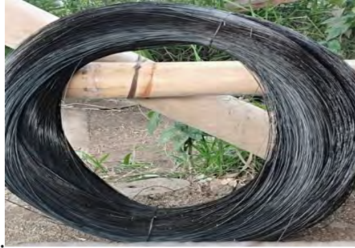
Gambar 2.20.Kawat bendrat (Dokumentasi Proyek, 2025)
