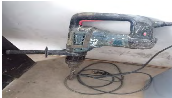
Gambar 3. 5 Jack Hammer (Dokumentasi Proyek, 2025)
