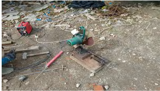
Gambar 3. 9 Bar Cutter (Dokumentasi Proyek, 2025)
