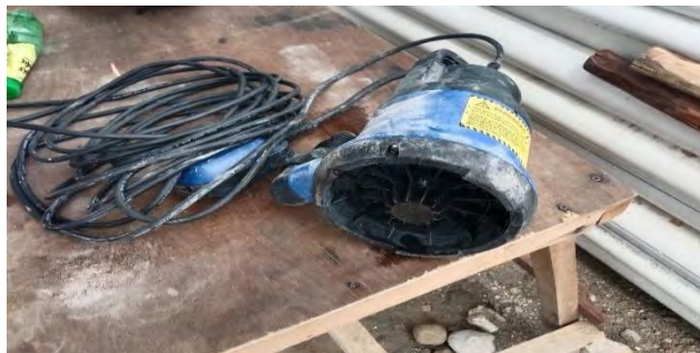
Gambar 3.2. 42 Submersible Pump (Dokumentasi Proyek, 2025)
