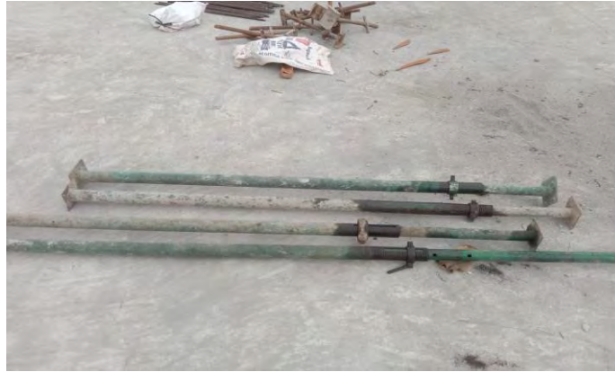
Gambar 3.2. 46 Arow Prop (Dokumentasi Proyek, 2025)
