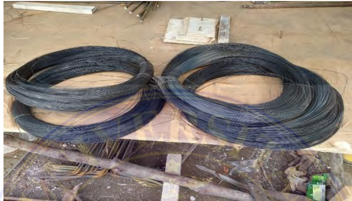
Gambar 3.3 22 Bendrat ( kawat Beton ) (Dokumentasi Proyek, 2025)
