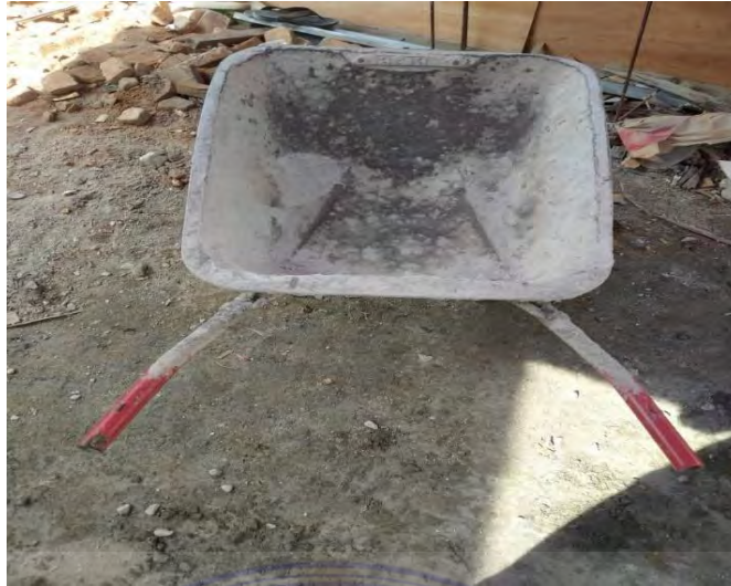
Gambar 3.2. 12 Kereta Sorong (Dokumentasi Proyek, 2025)
