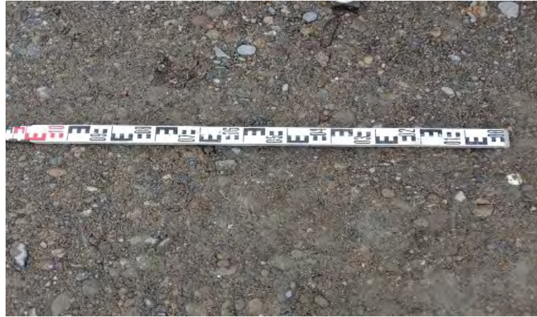
Gambar 3.2. 49 Bak Ukur (Dokumentasi Proyek, 2025)
