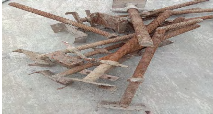
Gambar 3.2. 44 U-Head (Dokumentasi Proyek, 2025)
