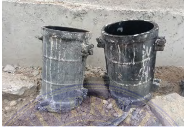
Gambar 3.2. 37 Bekisting Sampel Silinder (Dokumentasi Proyek, 2025)
