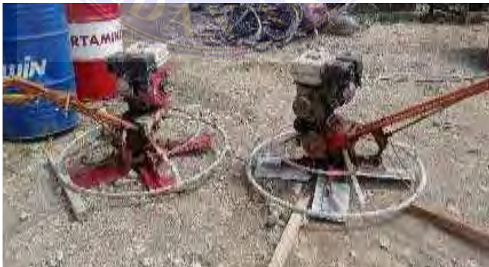
Gambar 3.3.7 Trowel (Dokumentasi Proyek,2025)
