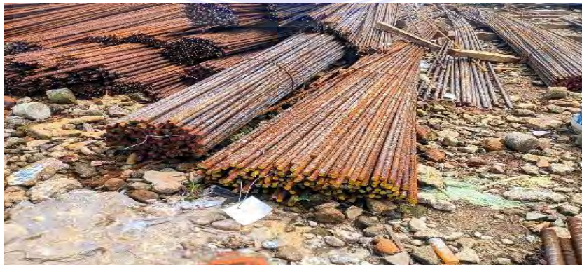
gambar 3.4 2 Besi Tulangan (Dokumentasi Proyek,2025)
