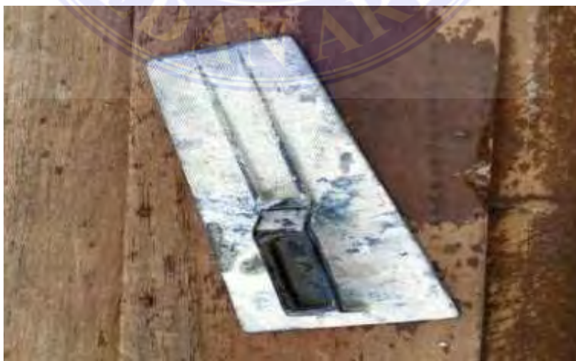
Gambar 3.3.15 Raskam (Dokumentasi Proyek,2025)
