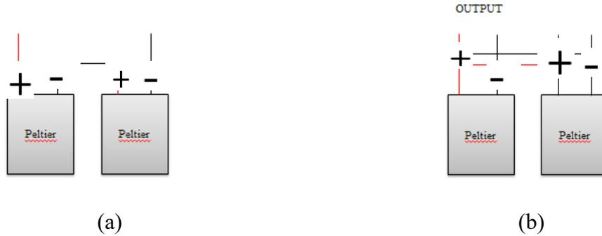
**Gambar 3.4** dua buah Peltier menggunakan rangkaian seri dan parallel
