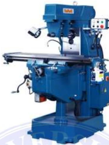
Gambar 2.3. Mesin Frais Tangan
