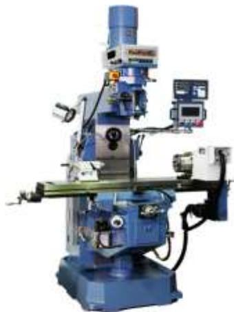
Gambar 2.5. Mesin Frais Tipe Spesial
